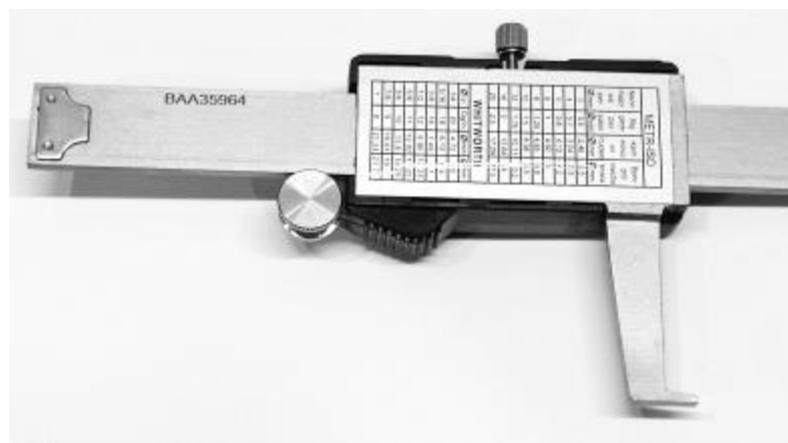
Рисунок 12 – Место нанесения заводского номера
